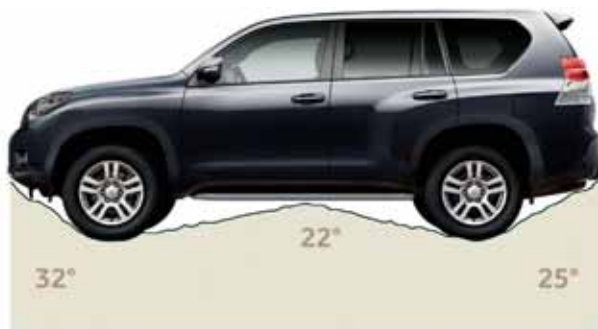
Rampvinkel mellan hjulparen 22° Frigångsvinkel fram 32° Frigångsvinkel bak 25°
